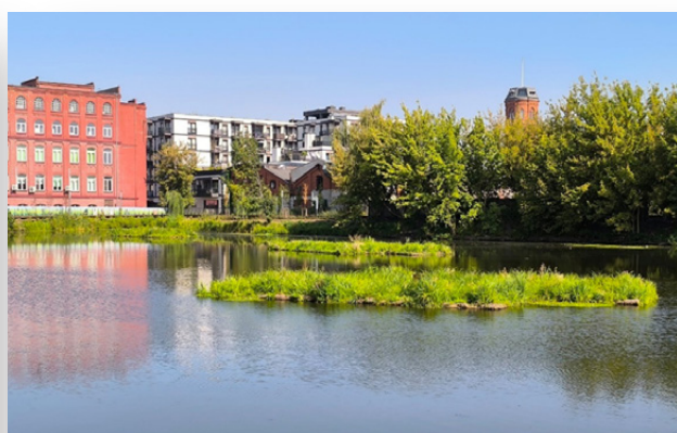
Roślinne wyspy filtracyjne w Żyrardowie. Pełnią rolę filtrów oczyszczających wodę oraz miejsca schronienia i gniazdowania ptaków.
